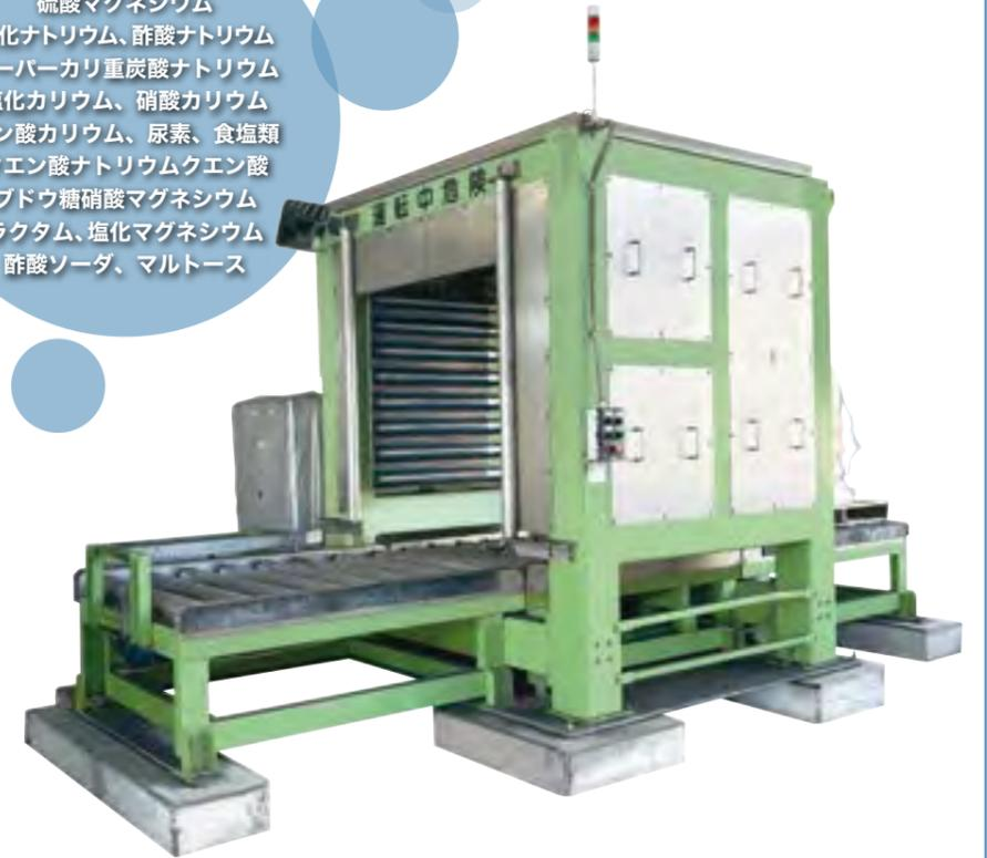
フレコンバッグブレーカ自動制御式
