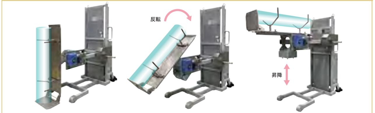
**ロール倒立機 T型 ジャバラ付き** ●リンク部分をジャバラでカバーし、安全性強化 **OM**
