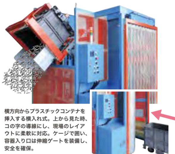
横方向からプラスチックコンテナを挿入する横入れ式。上から見た時、コの字の導線にし、現場のレイアウトに柔軟に対応。ケージで囲い、容器入り口は伸縮ゲートを装備し、安全を確保。
