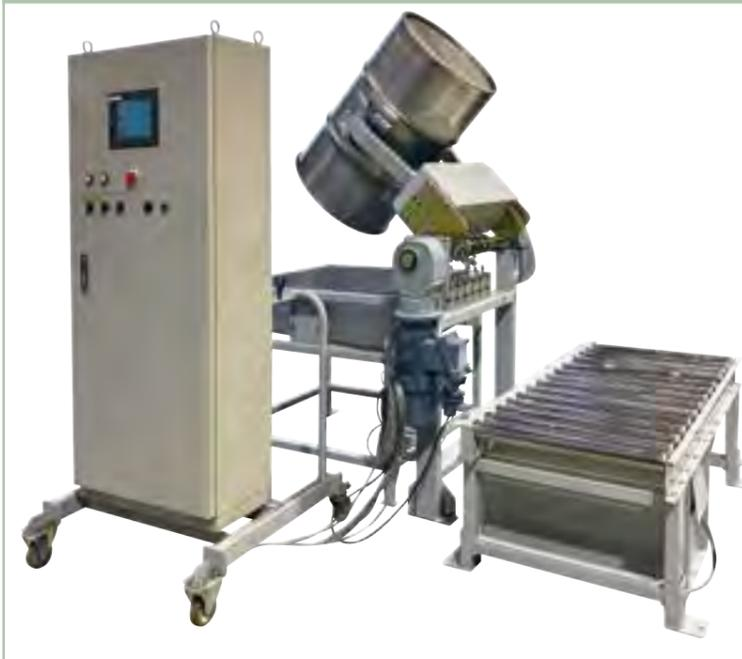
ドラム缶用 H型定置式 SUS製
