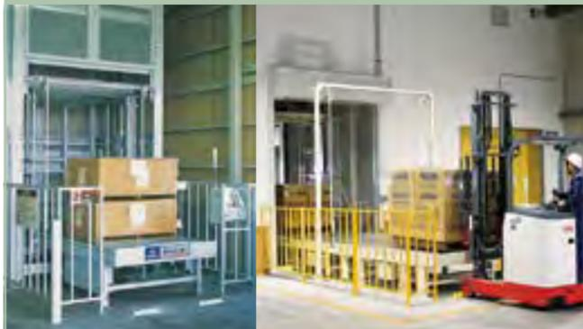
荷受部を昇降させる垂直搬送部 (本体)、荷受部に荷物を自動で出入する水平搬送部 (搬入出コンベヤまたは搬入出装置) で構成
