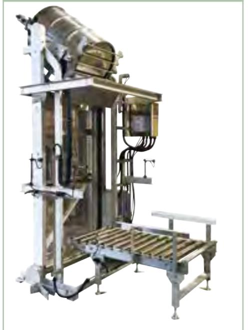
粉体、粒体、液体の入った容器を所定の高さまでリフトアップし反転させ内容物を供給する投入装置 設置面積が小さく省スペースで使用可能
